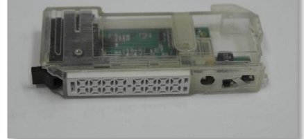
작고 미세한 형상의 디자인 및 조립성 테스트를 위한 광센서 시제품 제작 (PolyJet 기술)
